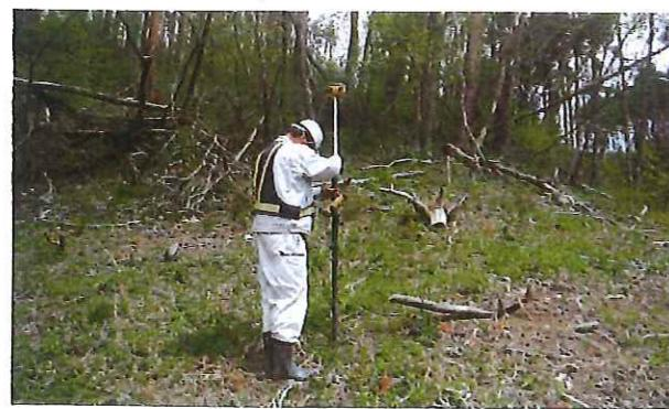
図-3 GNSSによる横断測量
