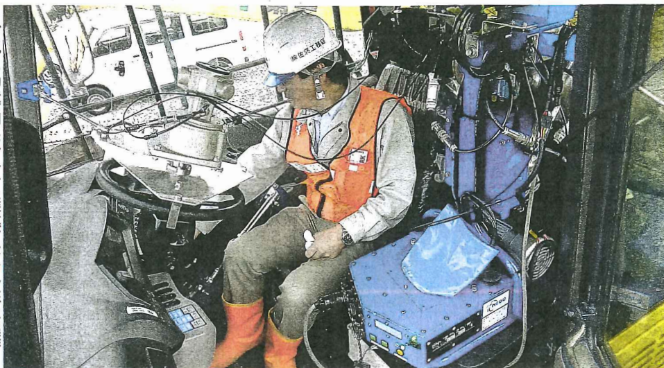
ダンプの助手席側に取り付けた装置がハンドルなどを操作
